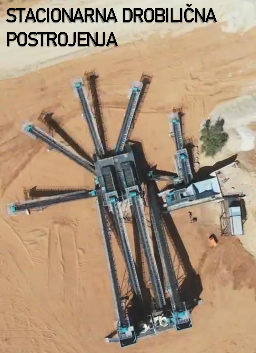
**CONSTMACH** projektuje i proizvodi stacionarna postrojenja za drobljenje i prosejavanje različitih konfiguracija i kapaciteta a sve u skladu sa potrebama i zahtevima klijenata. Prizvodni kapaciteti naših postrojenja za drobljenje drobljenje i prosejavanje idu od 50 do 1.000 tona na čas.
