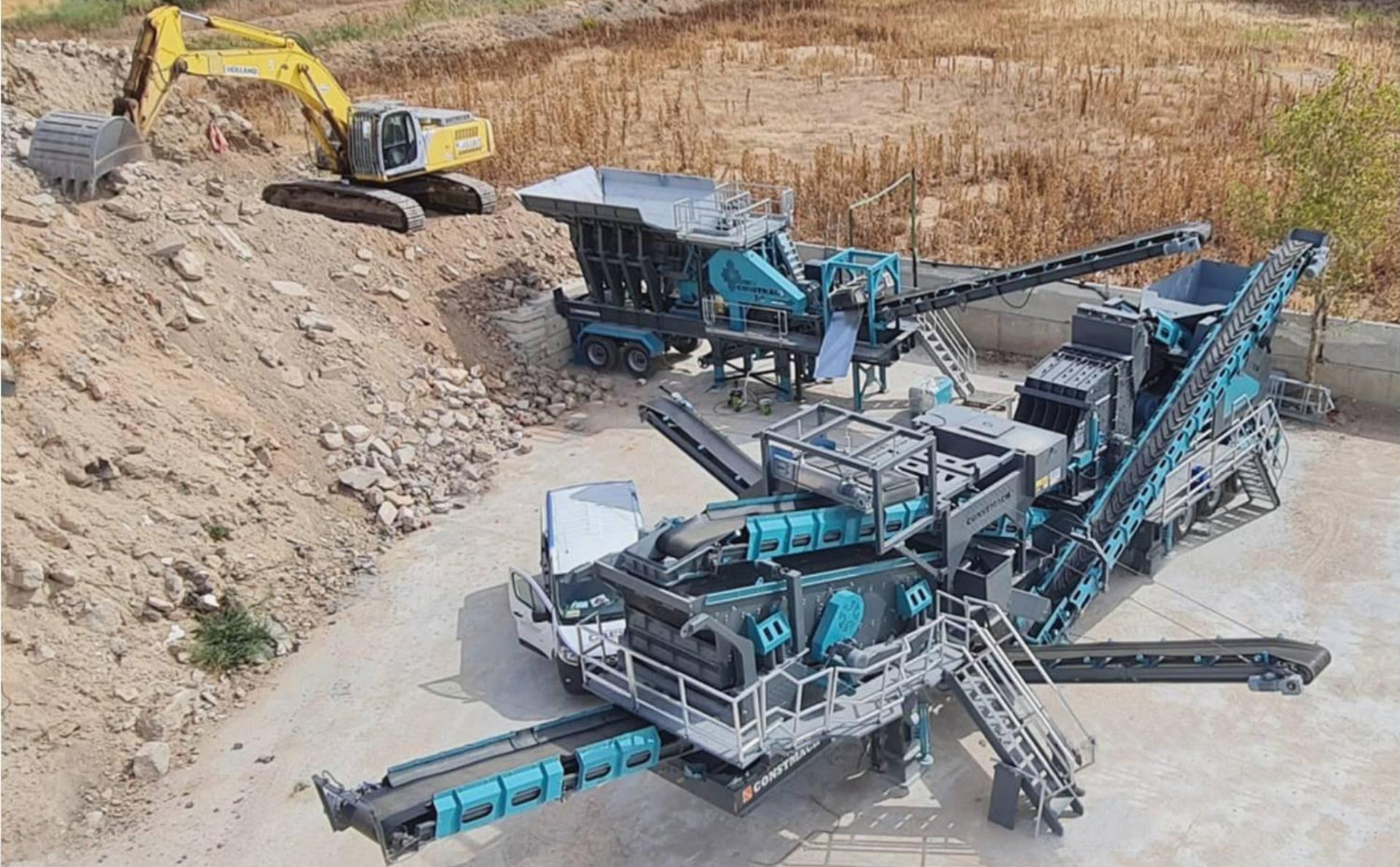
**CONSTMACH mobilne čeljusne i udarne drobilice** koriste se za drobljenje širokog spektra stena, od krečnjaka do bazalta. Prisustvo primarne čeljusne drobilice omogućava drobljenje velikih i tvrdih stena. Sa druge strane, zahvaljujući sekundarnoj udarnoj drobilici, moguće je proizvesti dobar kubični oblik finalnih materijala od 0 do 60 mm prema potrebama kupaca.
