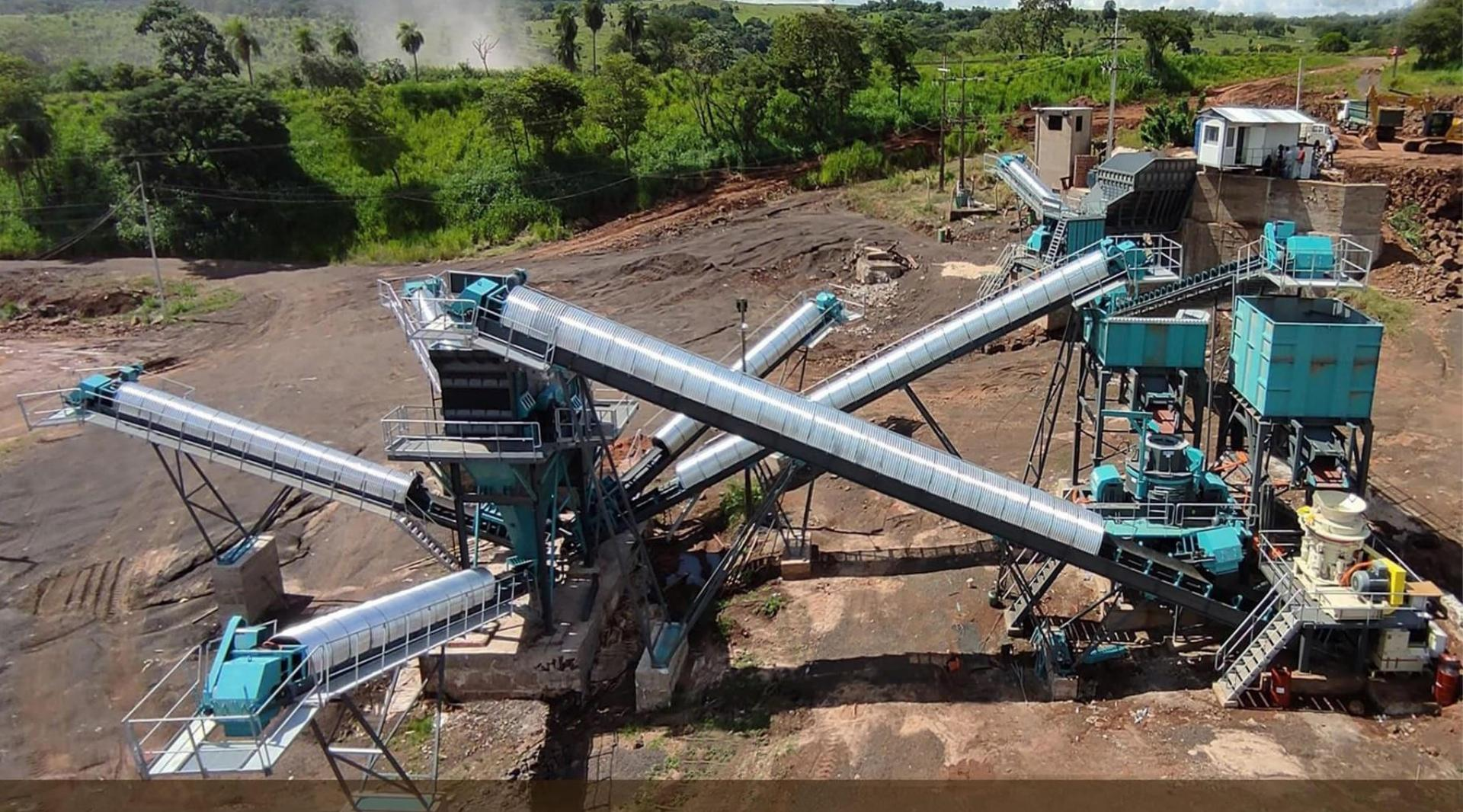
**FIX JCV-3 / STACIONARNO POSTROJENJE ZA DROBLJENJE I PROSEJAVANJE**
