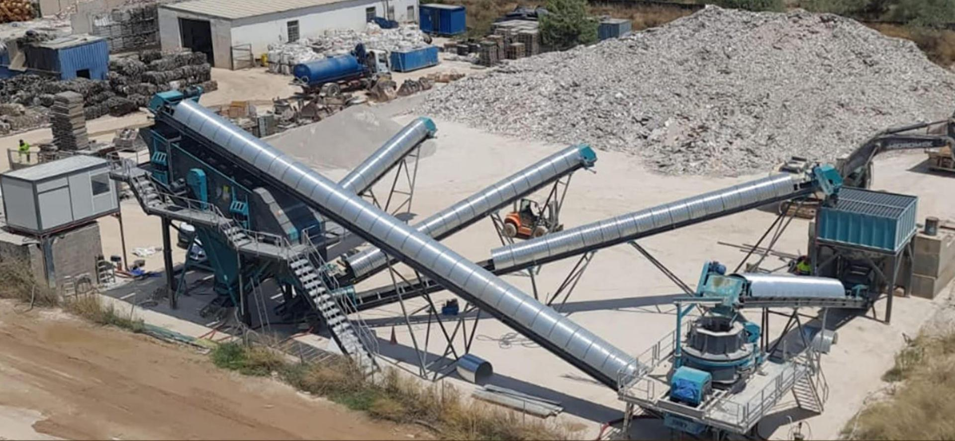
**FIX-V-90 / STACIONARNO POSTROJENJE ZA DROBLJENJE I PROSEJAVANJE**
