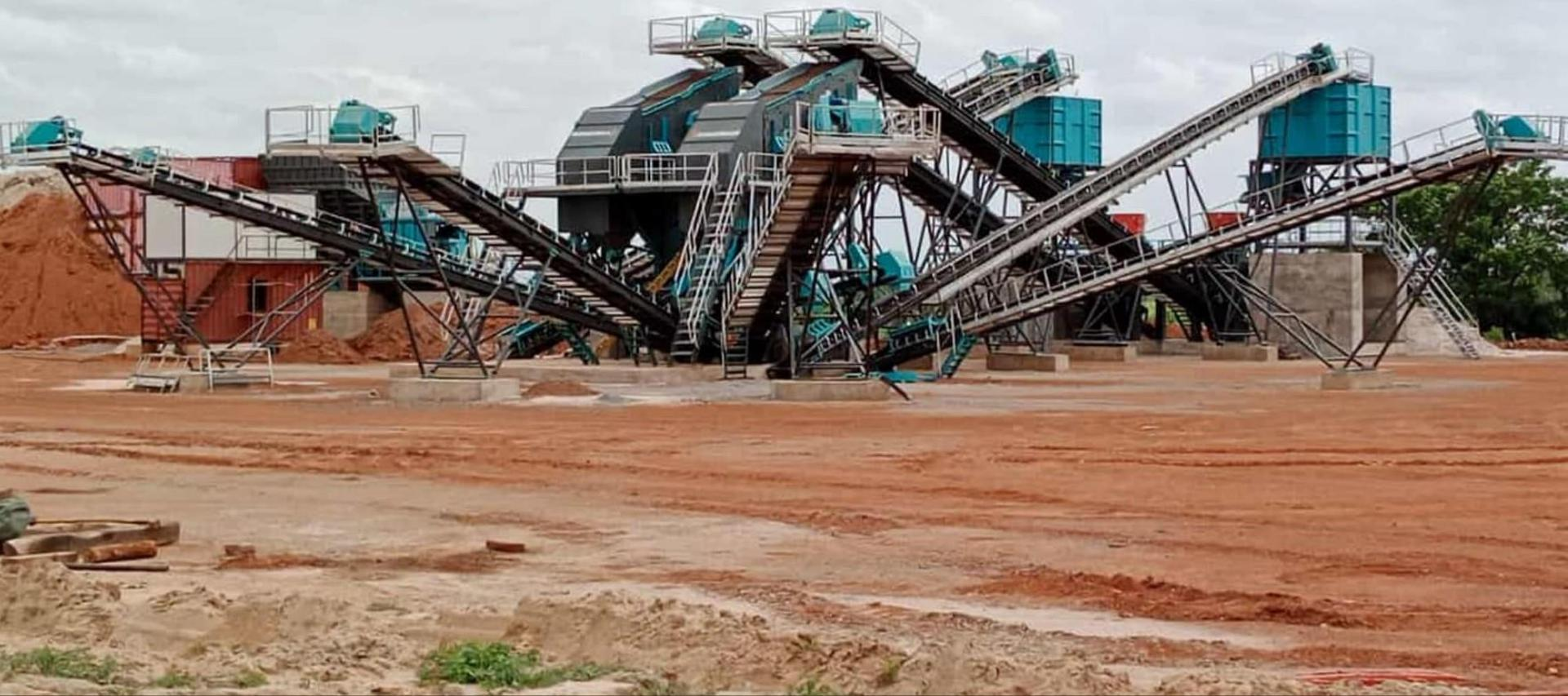
**FIX JCC-2 / STACIONARNO POSTROJENJE ZA DROBLJENJE I PROSEJAVANJE**
