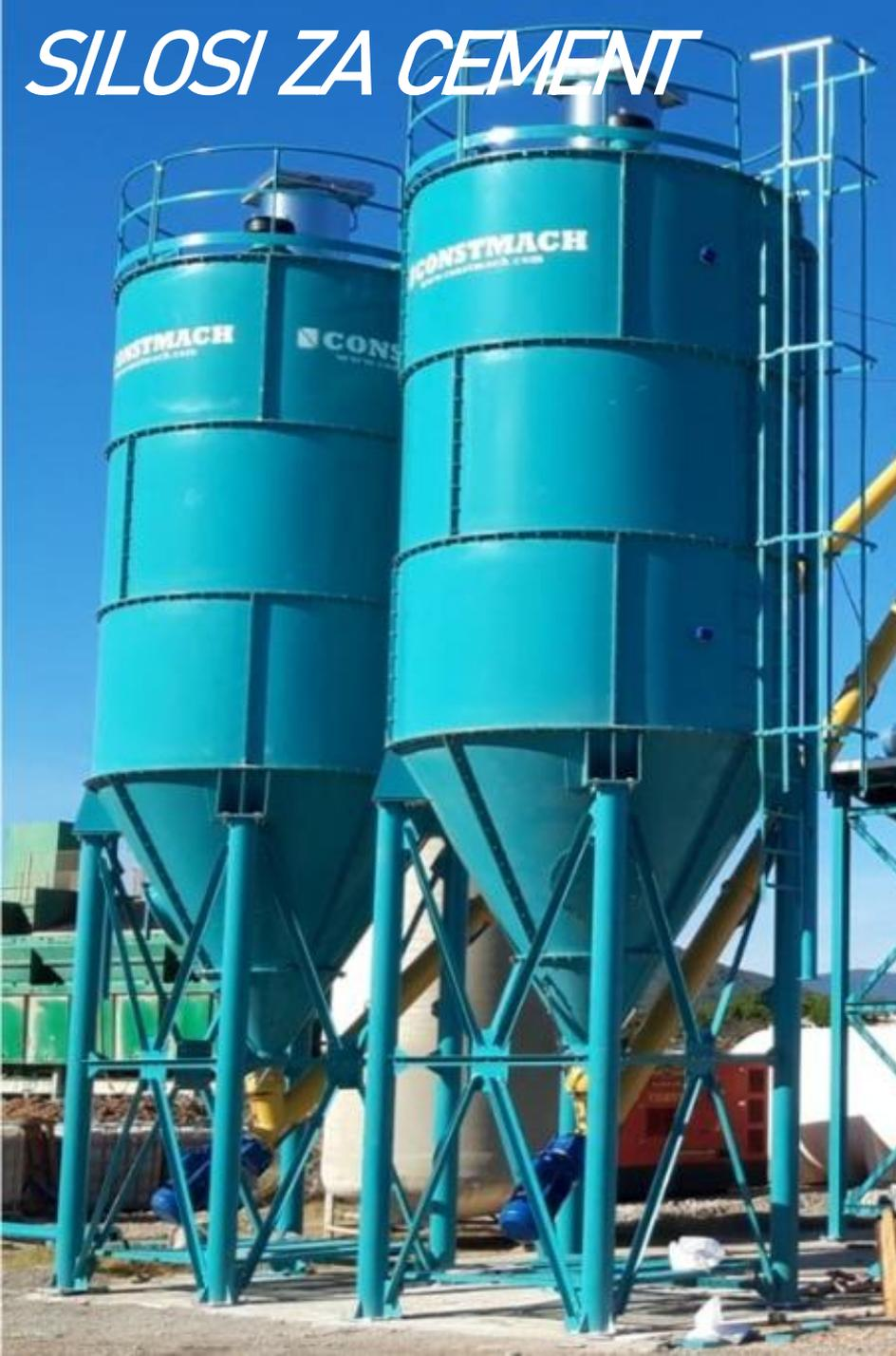
CONSTMACH proizvodi različite veličine i tipove silosa za skladištenje cementa od 50 do 3.000 tona skladišnog kapaciteta. Silosi za cement se koriste ne samo u fabrikama betona, već se koriste i za samostalne namene kao što su cementni terminali, fabrike cementa i projekti skladištenja krečnjaka u prahu.
