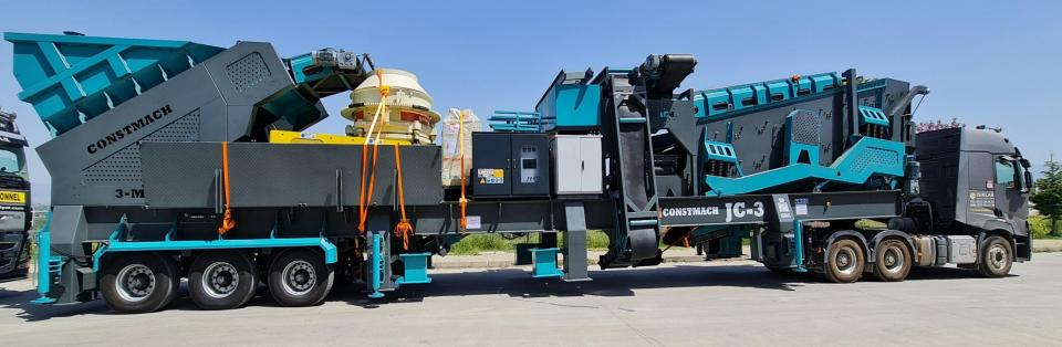
Серии JC и JCV: Мобильные Дробильные заводы для твердого камня
