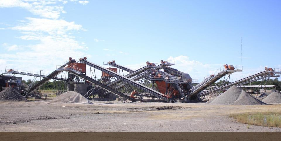
FIX JCV-3 / СТАЦИОНАРНАЯ ДРОБИЛЬНО-СОРТИРОВОЧНАЯ УСТАНОВКА
