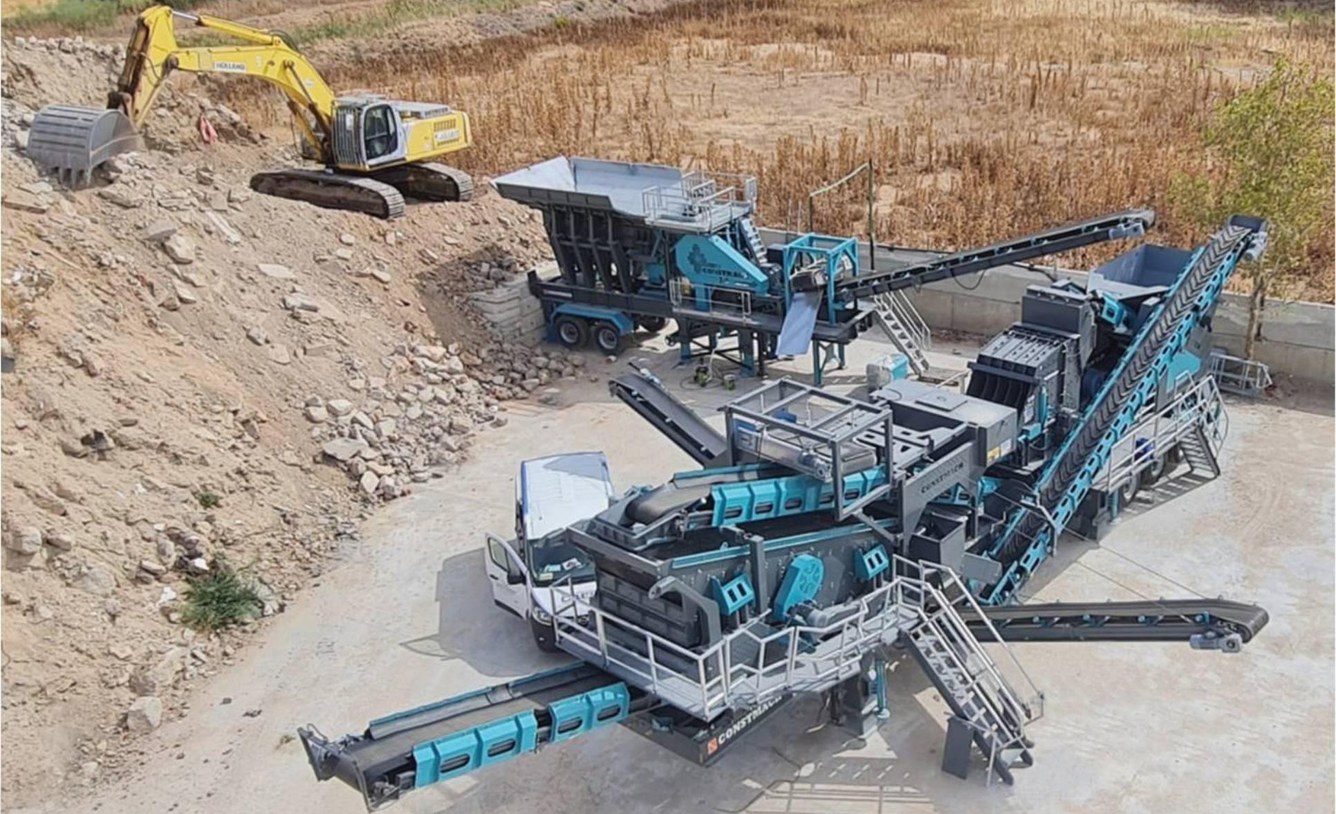
Мобильные щековые и ударные дробильные заводы **CONSTMACH** используются для дробления широкого спектра горных пород, от известняка до базальта. Наличие первичной щековой дробилки позволяет дробить крупные и твердые породы. С другой стороны, благодаря вторичной роторной дробилке можно производить готовые материалы хорошей кубической формы от 0 до 60 мм в соответствии с потребностями заказчика.
