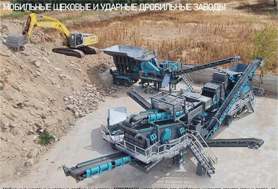
Мобильные щековые и ударные дробильные заводы **CONSTMACH** используются для дробления широкого спектра горных пород, от известняка до базальта. Наличие первичной щековой дробилки позволяет дробить крупные и твердые породы. С другой стороны, благодаря вторичной роторной дробилке можно производить готовые материалы хорошей кубической формы от 0 до 60 мм в соответствии с потребностями заказчика.
