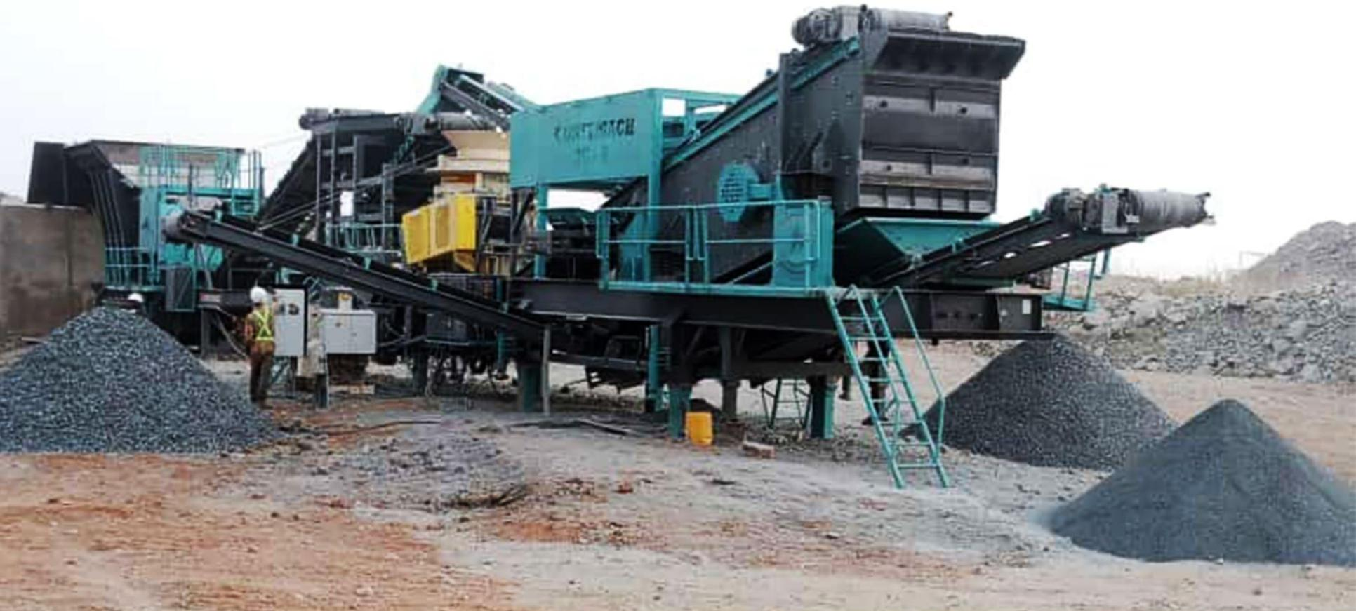
JC-2 / MOBILE CRUSHING AND SCREENING PLANT
