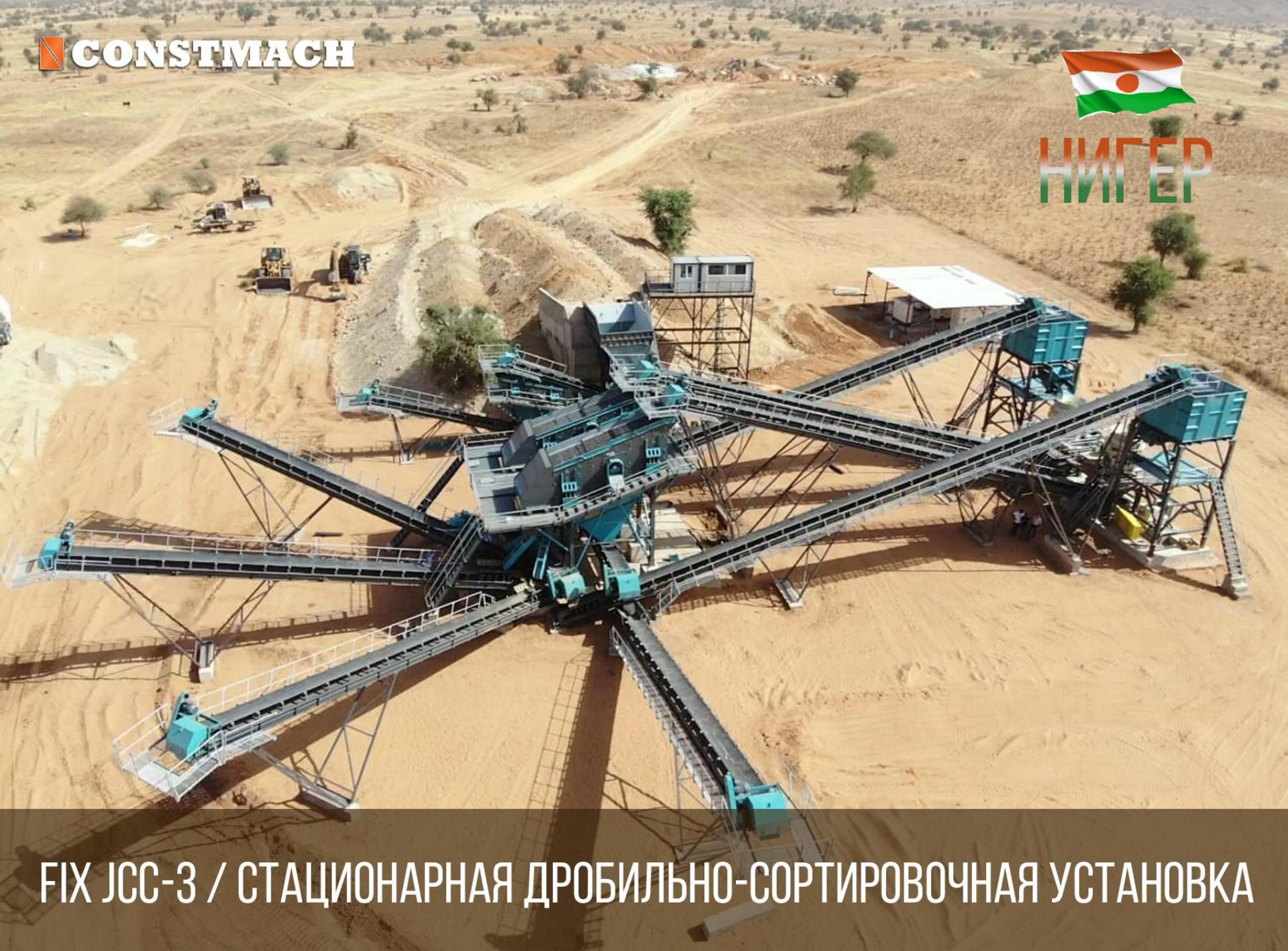
**FIX JCS-3 / СТАЦИОНАРНАЯ ДРОБИЛЬНО-СОРТИРОВОЧНАЯ УСТАНОВКА**
