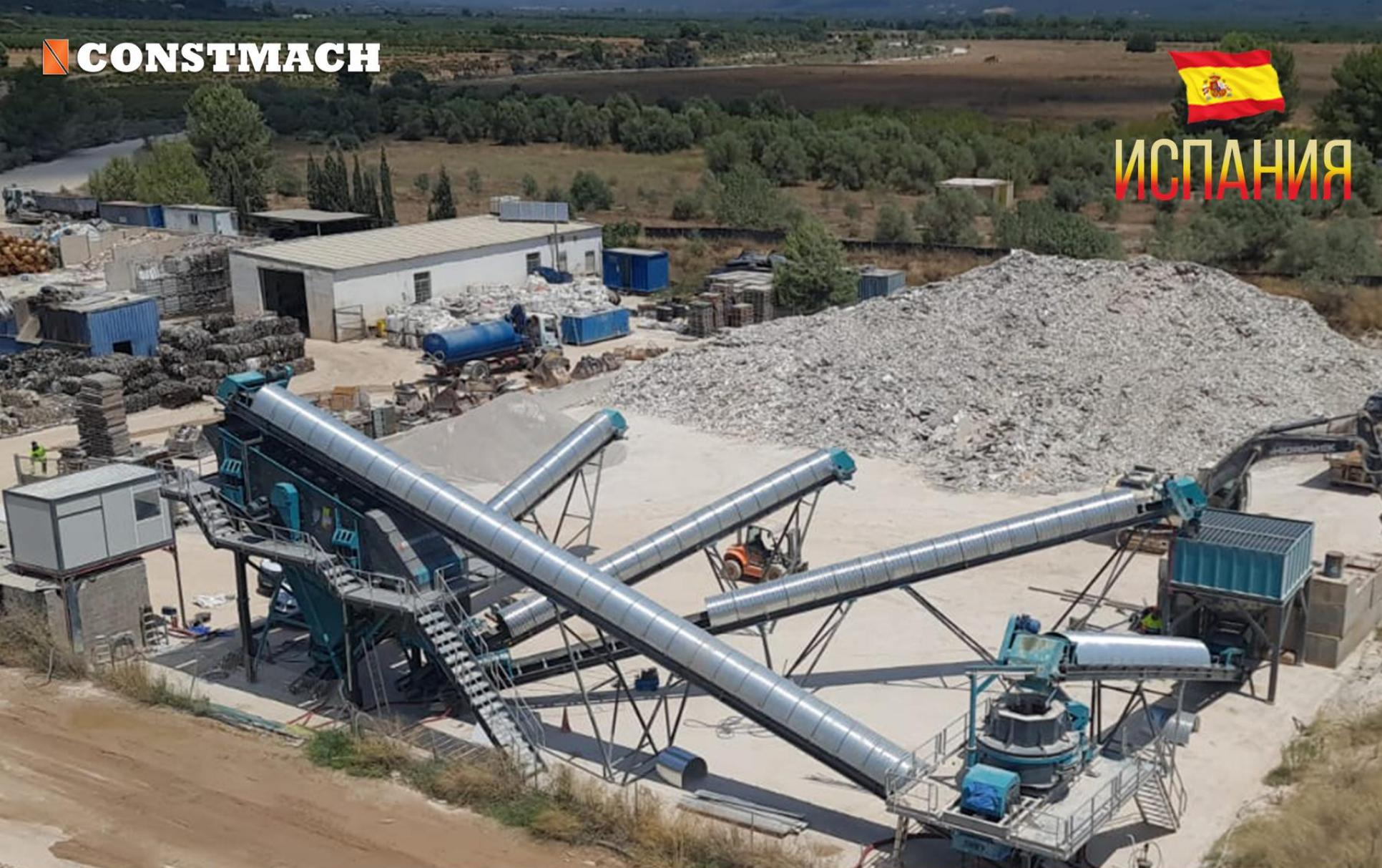
**ФИКС-В-90 / СТАЦИОНАРНАЯ ДРОБИЛЬНО-СОРТИРОВОЧНАЯ УСТАНОВКА**
