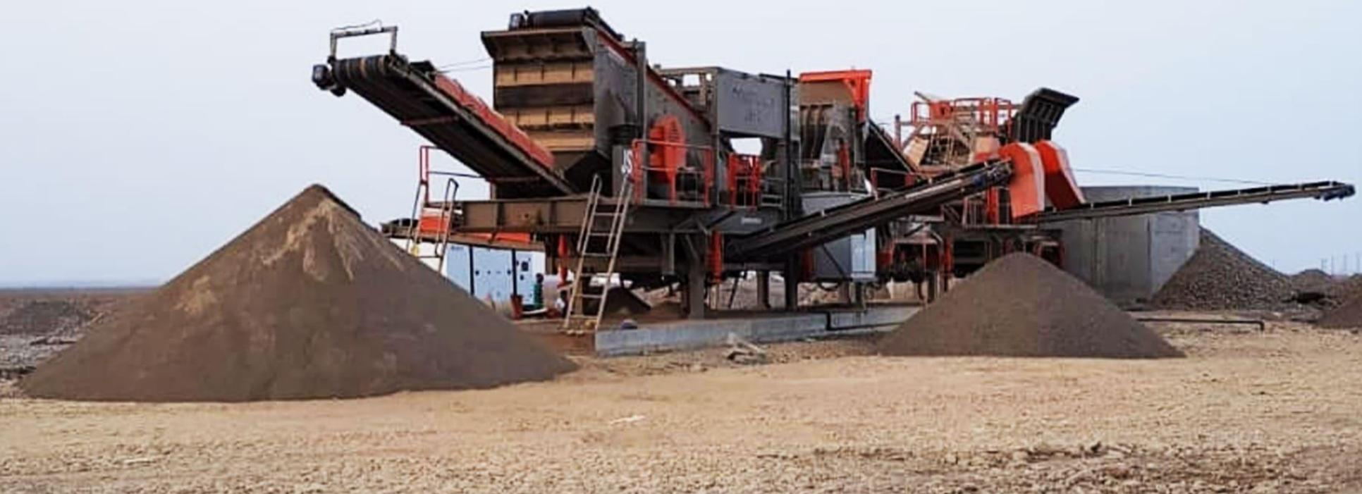
**JS-2 / MOBILE CRUSHING AND SCREENING PLANT**
