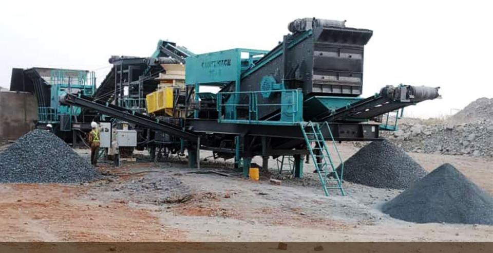
JC-2 / MOBILE CRUSHING AND SCREENING PLANT
