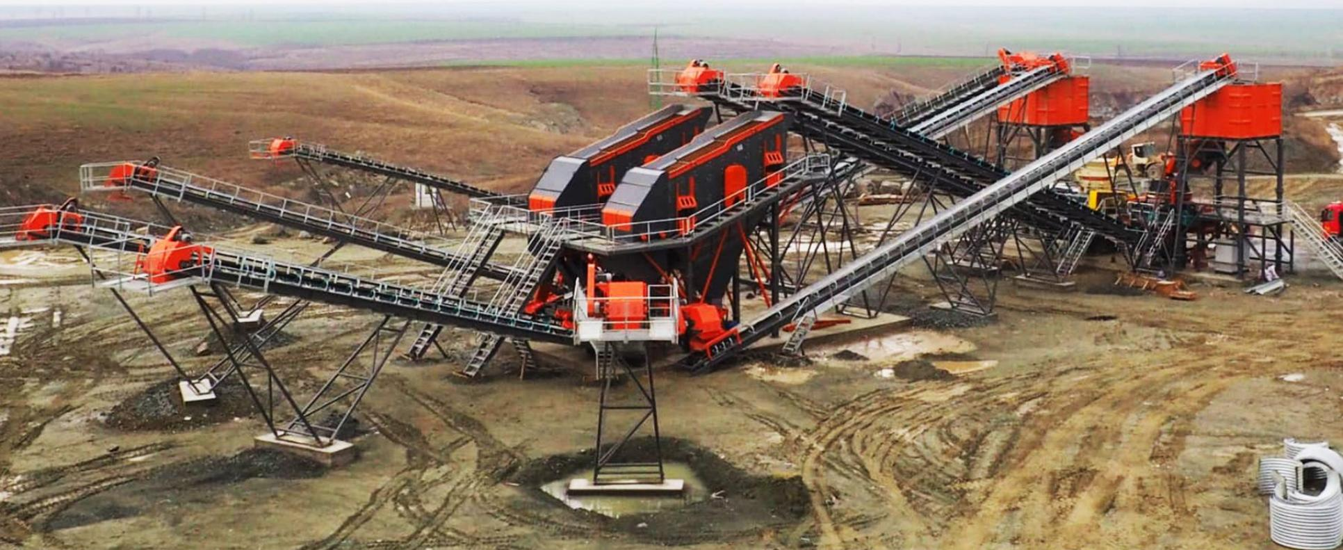
FIX JCV-3 / СТАЦИОНАРНАЯ ДРОБИЛЬНО-СОРТИРОВОЧНАЯ УСТАНОВКА
