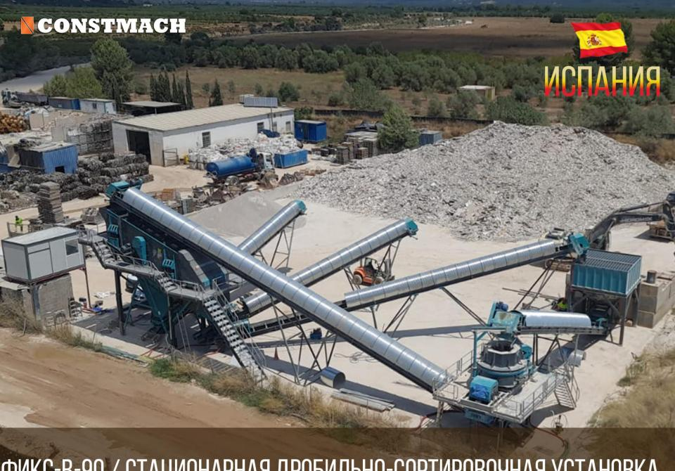
ФИКС-В-90 / СТАЦИОНАРНАЯ ДРОБИЛЬНО-СОРТИРОВОЧНАЯ УСТАНОВКА
