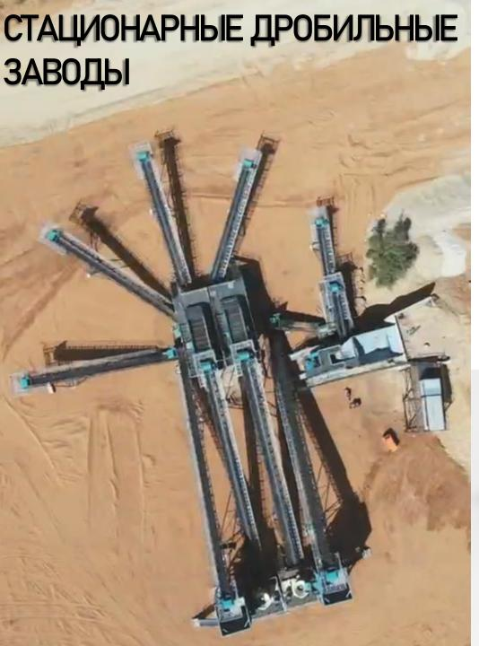
**CONSTMACH** проектирует и производит Стационарные Дробильно-Сортировочные заводы различной конфигурации и производительности в соответствии с потребностями и предпочтениями клиентов. Производительность наших дробильно-сортировочных заводов варьируется от 50 до 1000 тонн в час.
