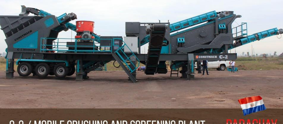
C-2 / MOBILE CRUSHING AND SCREENING PLANT
