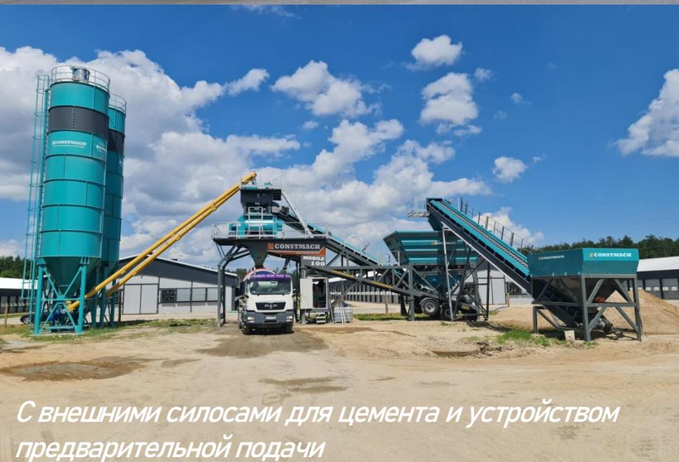
*С внешними силосами для цемента и устройством предварительной подачи*
