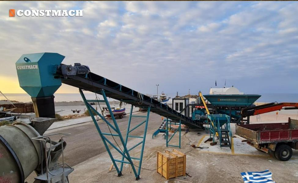
MOBICOM 30 / CENTRALE À BÉTON
