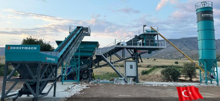
MOBILE 60 / CENTRALE À BÉTON MOBILE
