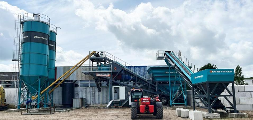
MOBILE 60 / CENTRALE À BÉTON MOBILE
