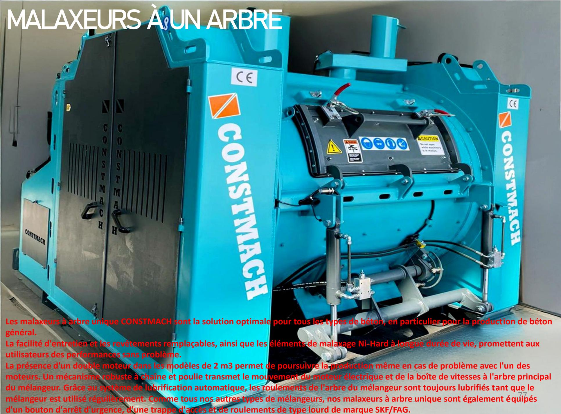
Les malaxeurs à arbre unique CONSTMACH sont la solution optimale pour tous les types de béton, en particulier pour la production de béton général.
