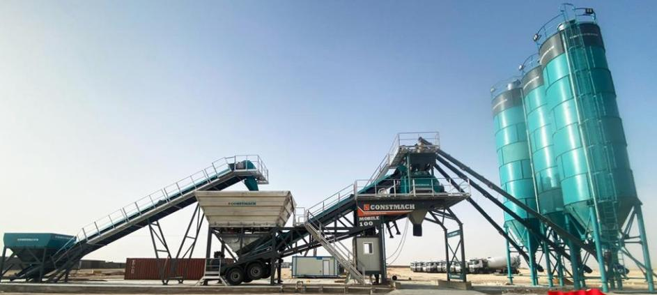
MOBILE 100 / CENTRALE À BÉTON MOBILE
