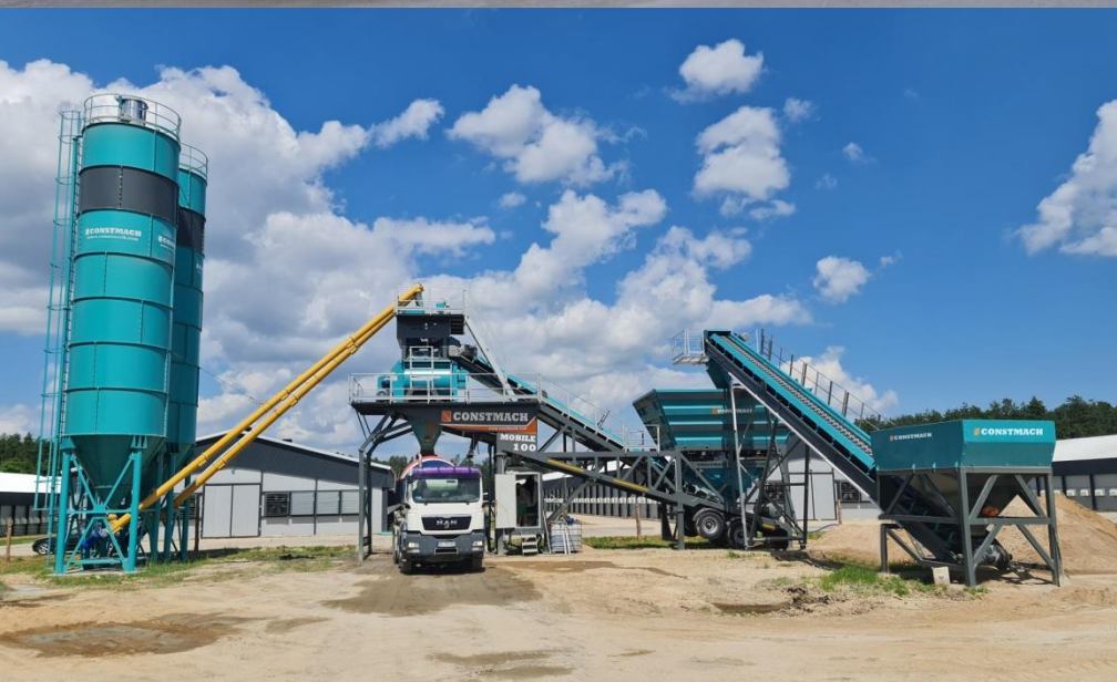
Avec silos à ciment externes et pré-alimentateur
