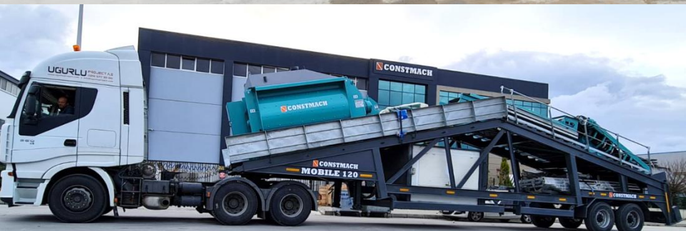
Position de transport du 1er châssis
