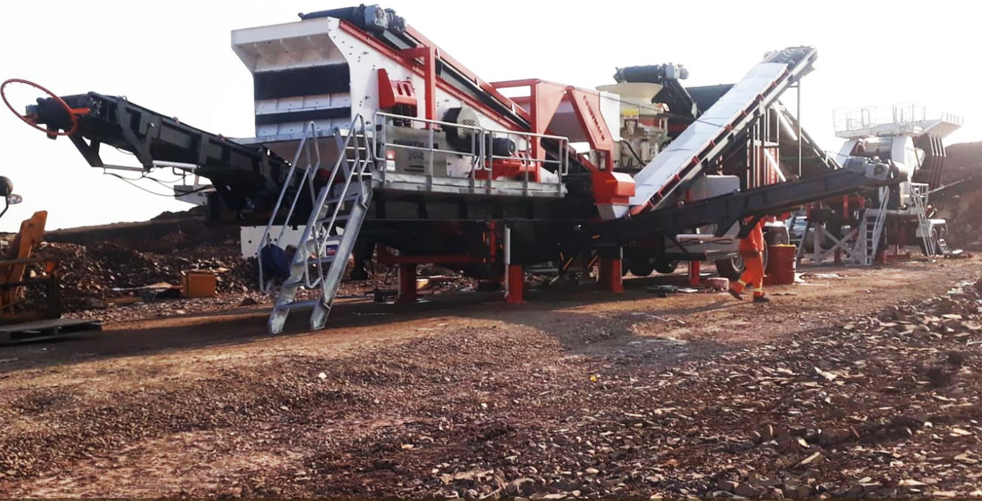
JS-2 / INSTALLATION MOBILE DE CONCASSAGE ET DE CRIBLAGE
