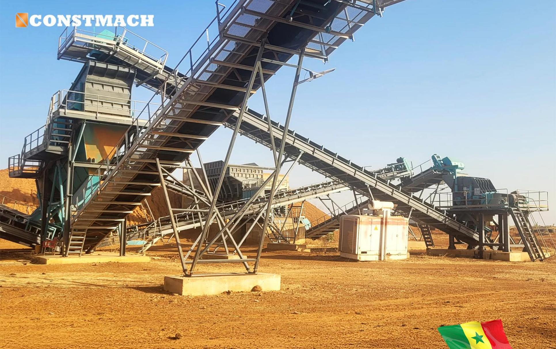
**JS-3 / STATIONARY CRUSHING & SCREENING PLANT**
