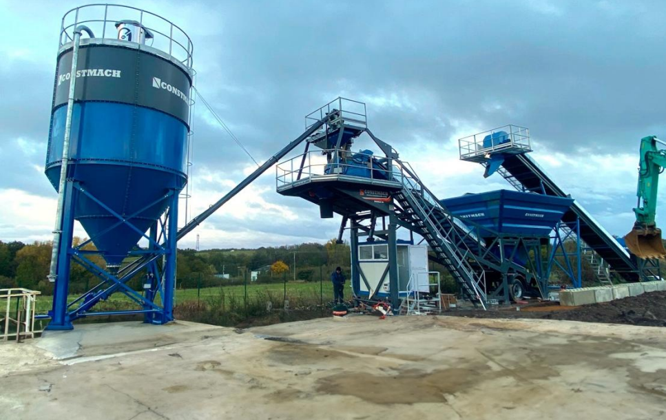
Harici çimento silosu ile kullanım
